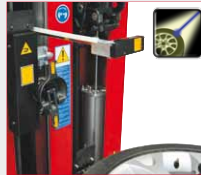
Teach-in-Verfahren der Raddaten und automatische Arbeitsabläufe
