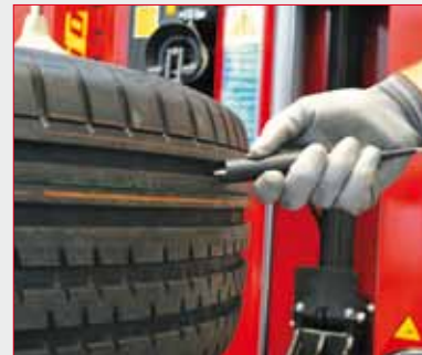
Messung der Tiefe der Reifenlauflfläche
