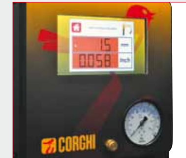
Daten der Tiefe der Reifenlauflfläche: auf rotem Hintergrund sind sie unter der Mindestgrenze
